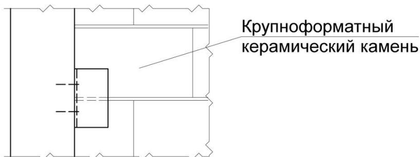
Марка камня в направлении  $\perp$  стене на смятие – не более марки М5 и зависит от формы пустот.
